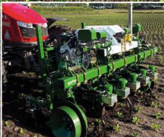
Robocrop InRow può lavorare anche se alcune piante sono cresciute ravvicinate tra loro, tuttavia per un buon funzionamento è importante una regolare separazione delle piante.
