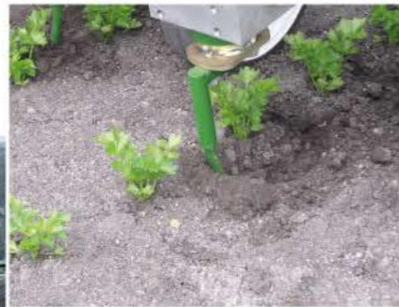
**eRotor:** alla versione con rotori idraulici Garford propone l'eRotor, modello con rotori ad azionamento elettrico alimentato da un generatore montato sulla macchina o dietro al trattore. Il motore elettrico consente tempi di reazione più rapidi per le comunicazioni tra la telecamera ed il rotore e di conseguenza una velocità di lavoro maggiore con miglior precisione.
