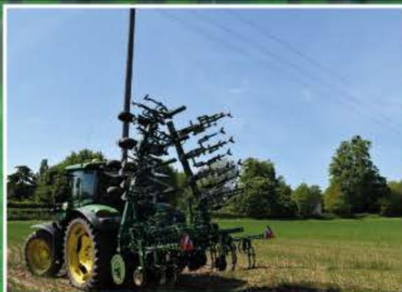
Telai richiudibili idraulicamente da 4,5m a 18 metri
