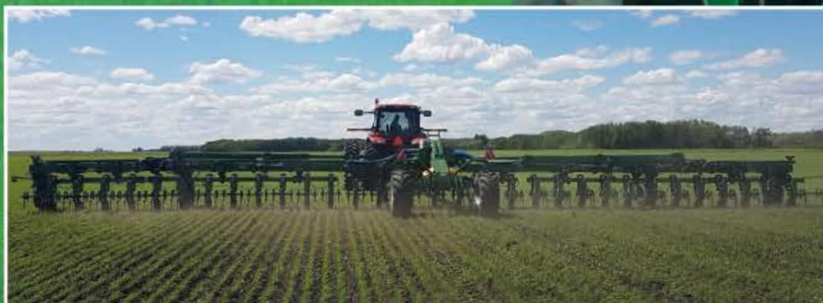
Garford può fornire telai rigidi o richiudibili idraulicamente per una larghezza di lavoro fino a 18 metri. Sono disponibili versioni con montaggio all'anteriore o al posteriore. È disponibile un sollevatore anteriore di 2° categoria per telai fino a 6 metri
