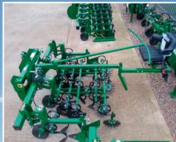
Garford propone una vasta gamma di sarchiatrici, dalle più piccole a guida manuale con larghezza di lavoro di 1.5m, fino a macchine di 18 metri trainate con il Robocrop precision Guided High Speed System.
